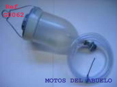
DEPÓSITO GASOLINA PARA PRUEBAS CON SOPORTE PARA COLGAR
