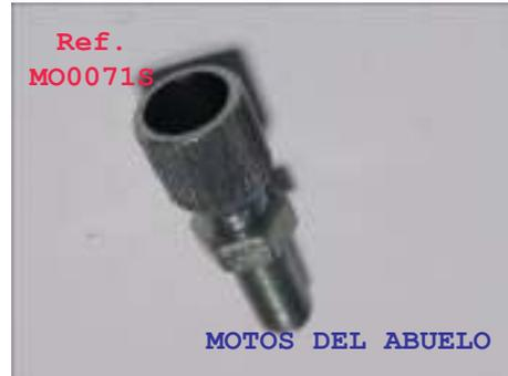
**TENSOR CABLE GAS CARBURADOR IRZ 18 AE, AEB Y AEZ**
