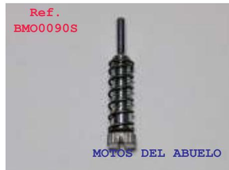
**TORNILLO RALENTÍ CARBURADOR IRZ EC, CT DE 22, 24 y 27 MM**
